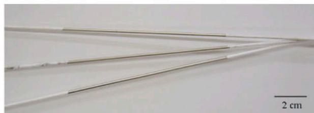
図2：パラジウム膜を用いたベンゼンからフェノールの直接合成
