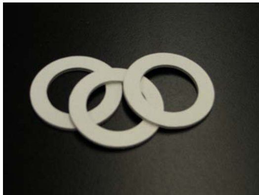
今回開発したガスケット試作品の外観
