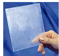
【不燃透明複合材】 車面用照明カバーへの応用が 期待されます (株式会社呂城化成)
