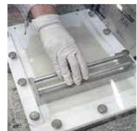
【ラボ用粘土膜製膜器】 水系・各種有機溶剤に 対応しています (株式会社ジー・イー・エス)
