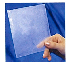
【不燃透明複合材】 車両用照明カバーへの応用が 期待されます (株式会社宮城化成)
