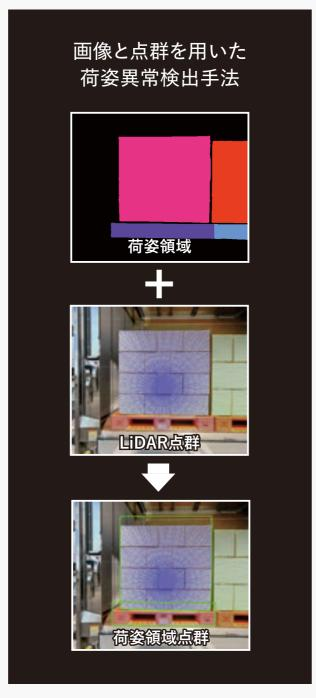
②荷物のはみ出しが30mm以内で回避動作可能と判定した場合、フォークをパレットに差し込み、回避動作をして荷下ろし作業を続行します。荷物のはみ出しが30mm以上の場合など、回避動作が不可能だと判定した場合は、作業を停止します。
