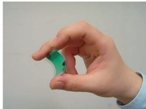
軽く、柔らかく、カラフルな有機薄膜太陽電池
