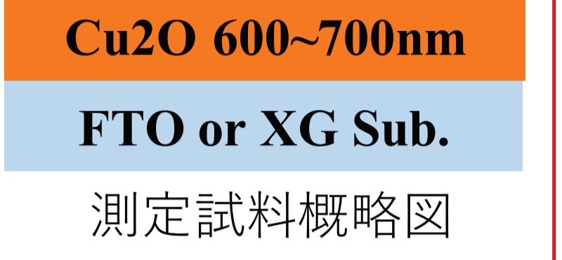
図2 RS-MBE装置でのCu 2 O膜の成膜
