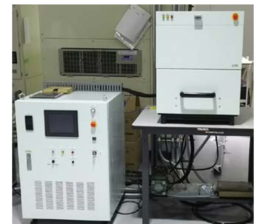
LED赤外光照射装置(IF855-180/180, カンタムエレクトロニクス) λ = 855 nm, 最大照度4W/cm 2 , 温度制御: 100~300°C
