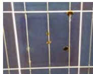
実際の焼損セル
