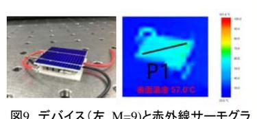
図9 デバイス(左、M=9)と赤外線サーモグラフィ像(右、光照射下 4.6 suns、下面 25°C)
