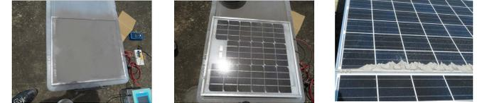
Fig. 3. 降灰時の太陽電池モジュール外観
