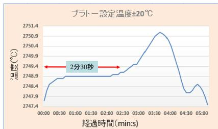
図2 校正プラトー温度(2747.4°C) ±20°C設定
