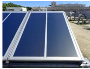
図1 曝露しているOPVアレイ。 4直列×4並列×2アレイ=32枚。
