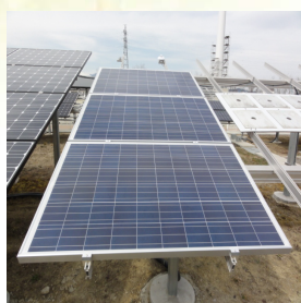
作製したモジュールの屋外暴露試験の様子
