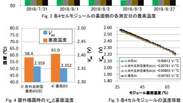
Fig. 4 屋外曝露時のV<sub>oc</sub>と裏面温度 (2018/8/27 13:35~13:40平均値)
