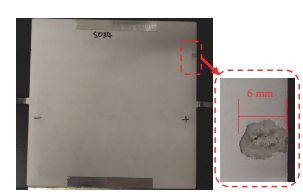
図6. インパルス電圧(-100 kV設定)印加後のバックシート破損
