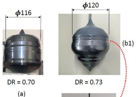
図3. 実際に成長できた大口徑比結晶の例。DR = 0.70の結晶(a)、DR = 0.73の結晶(b1)、(b2)。図(b1)と(b2)の結晶は同一のものである。
