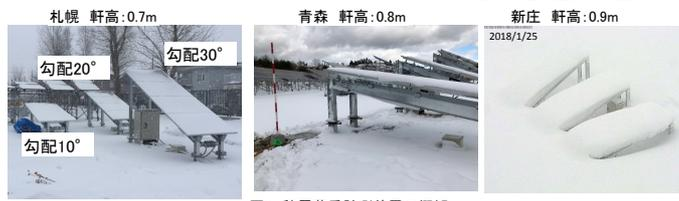
図1 積雪荷重計測装置の概要
