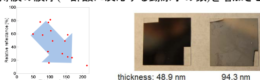
図4 膜厚と相対反射率の関係 図5 膜厚増加に伴う表面の白濁化
