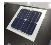
図-9 ガルバリウム鋼板/シリコン接着PVモジュール
