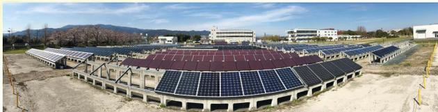
屋外に設置した様々な太陽電池モジュールを定期的に取り外し、ソーラーシミュレータを用いた標準試験条件での室内測定により経年劣化の振る舞いを比較検討(室内測定値と初期出力の関係)
