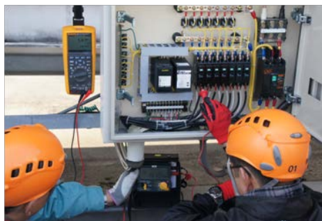
ストリング計測： ブロッキングダイオード検査、 絶縁抵抗測定、開放電圧測定、 ストリングI-V測定 静電容量、TDR
