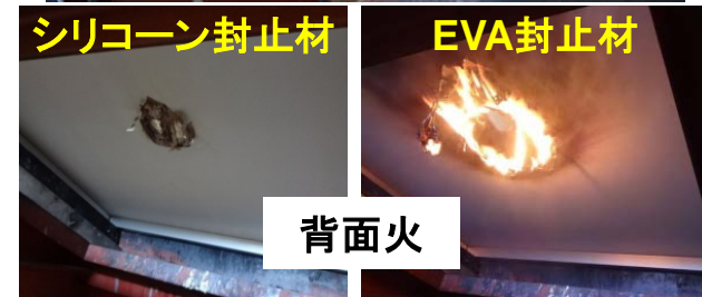
モジュールの飛び火試験 (難燃性モジュール開発: 信越化学工業との共同研究)
