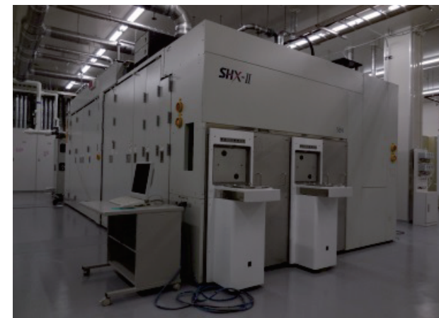
イオン注入装置
