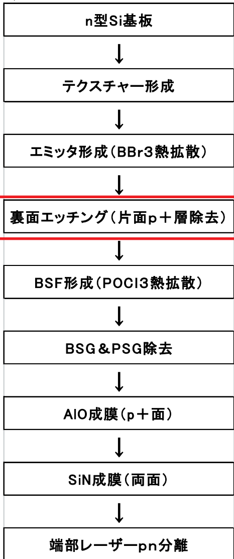
スピン法による裏面エッチング エッチング液: 日本化成(株)製
