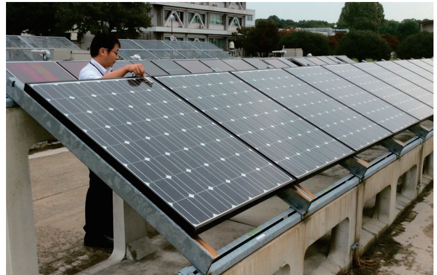
結晶 Si 太陽電池モジュールおよび各要素 セルの被接触電位測定(ガラス面より)
