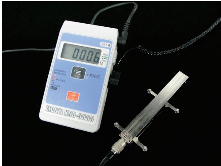
非接触型表面電位計 春日電機製 KSDシリーズ表面電位測定器カスタム品
