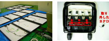
図12 バイパス回路の模擬開放故障
