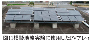
図11 模擬地絡実験に使用したPVアレイ
