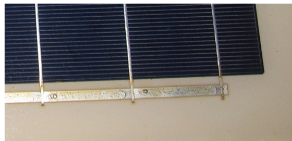
図 6.3.2. DH3000 時間後のタブ線の外観
