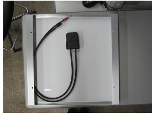
図 6.1.3. バナナ端子のチェックモジュール
