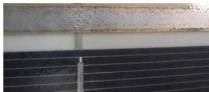
図-9 高温高湿 (85°C85%) 試験 2500 時間におけるインターコネクターの変色 (左：シリコーン封止、右：EVA 封止)
