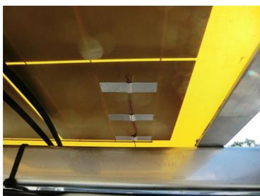
図 5 モジュール温度測定箇所(モジュール裏面)
