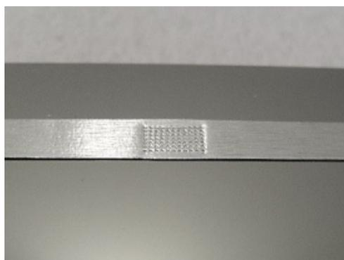
図 1 超音波電極接合した外観写真
