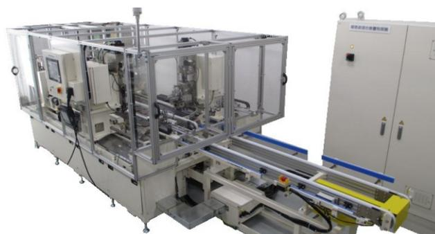
図 2 超音波電極接合装置
