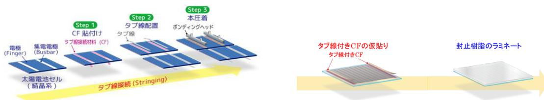
図 1 結晶系セルのストリング作製手順 図 2 薄膜系セルへのタブ線付き CF 接続作業手順
