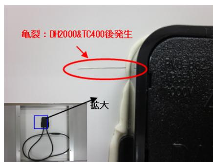
図 1. DH&TC 組み合わせ試験による外観不具合
