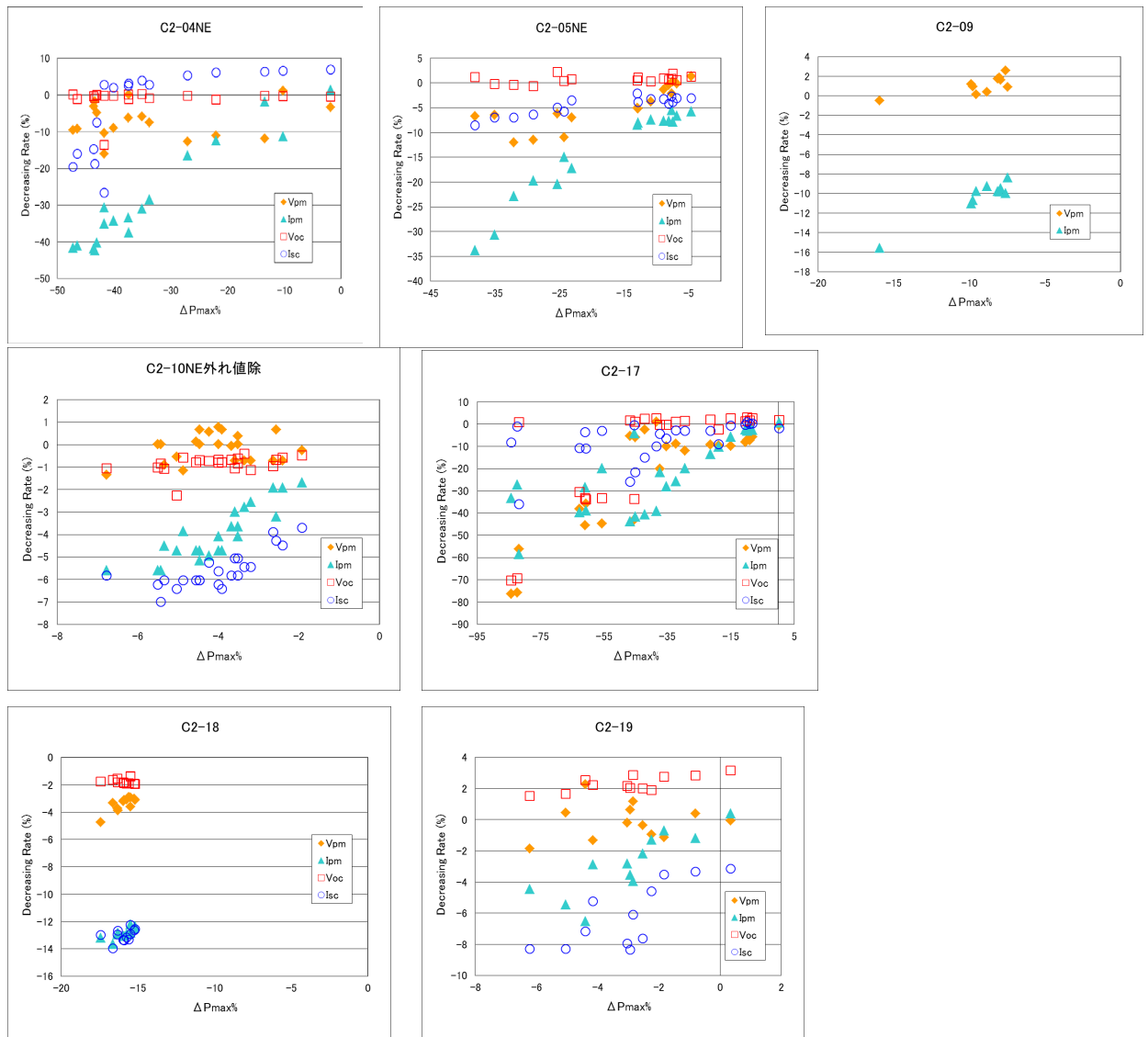
図 II-3-4-3. 各調査モジュールにおける Pmax と各 I-V パラメータの相関
