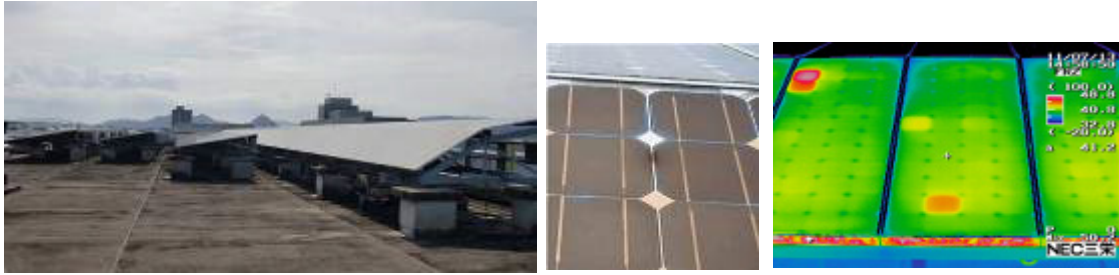
図 II-2-1-1. 産総研四国センターの曝露モジュール (左) 黄変と端子箱裏の焦げ (中央) 発熱異常のモジュール (右)
