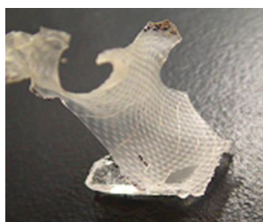
図Ⅲ-6-15. サンプル a の剥離したフィンガー電極
