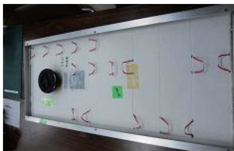
図 6.72 セル個別延長配線を延長取り出したモジュール
