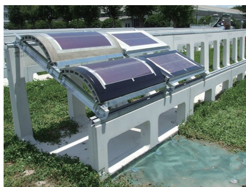
写真-6 産総研九州センター屋外曝露試験 場で試験中のAFR-PV貼付け モジュールと防草シート
