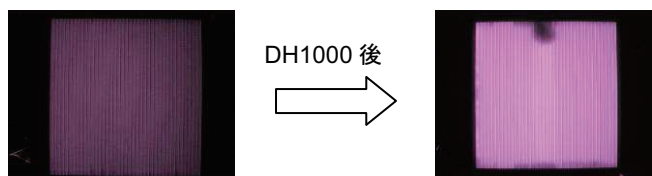
図 1B 端子ボックス付き産総研モジュールの初期(左)と DH1000 後(右)の EL 画像 DH1000 後には端子ボックス付近で発光がなくなっている
