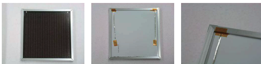
図 1A 試作モジュールでの配線引き出しの様子 セルのエッジ部で絶縁を確保した上で両極のタブ線を折り返して外部に引き出した
