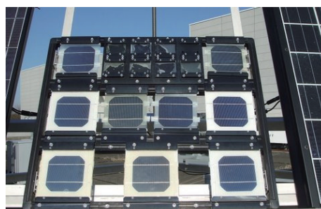
写真-3 産総研屋上 屋外曝露試験設置状況（太陽光追尾架台使用）
