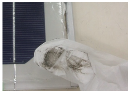
写真-4 1年曝露後ST品の表面汚れ
