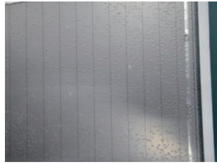
気泡発生の状況（バックシート剥離）
