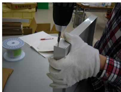
図 2 3. フレームのネジ止め
