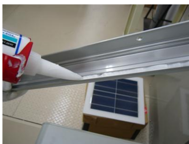
図 20. シール材の挿入
