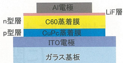
セルの基本構造 (p-nヘテロ接合型)
