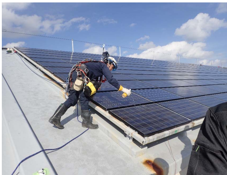
図 4.R3.4-6 モジュールを水で濡らしている様子（ストリング#01-01）
