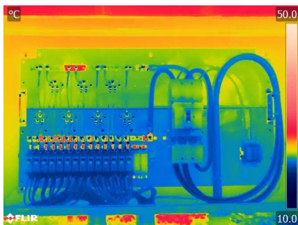
図 4.R3.3-6 接続箱内部の温度分布(接続箱#07)
