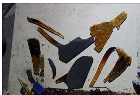
(b) 燃焼実験による太陽電池モジュールから脱落したガラス片写真
