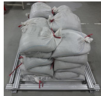
図 3.2.1-4 砂袋による終局耐力試験
