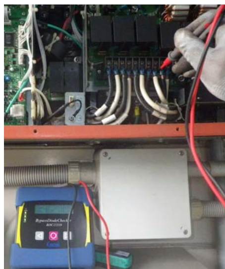
図 4.R2-23 バイパスダイオードチェッカ (日本カーネルシステム)
