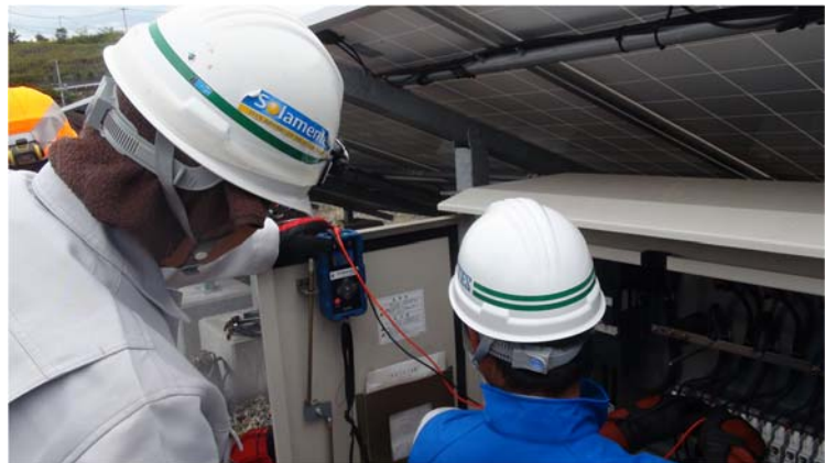
図 4.R3.6-15 ソラメンテ Z によるインピーダンス測定
