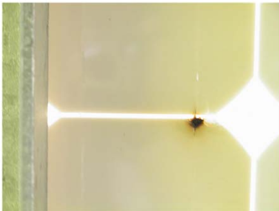
(c)セル裏面電極とインターコネクタのはんだ 接続部の導通不良に起因する褐色変
