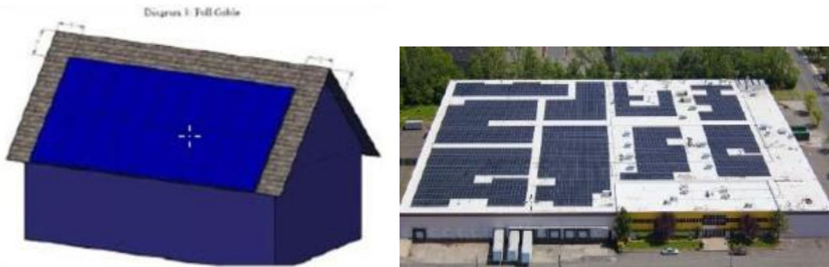
図 2.6.3-3 米国 IFC2012 に準拠した PV 設置例(左:住居用, 右:商業用陸屋根)
