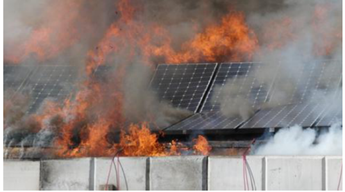
図 B4.1-7 実規模アレイによる燃焼実験
