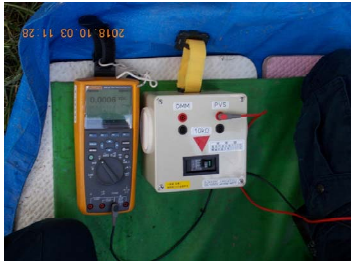
図 4.R3.1-4 V_{OC} ・ V_b 測定の様子(右:ブリーダ抵抗)
