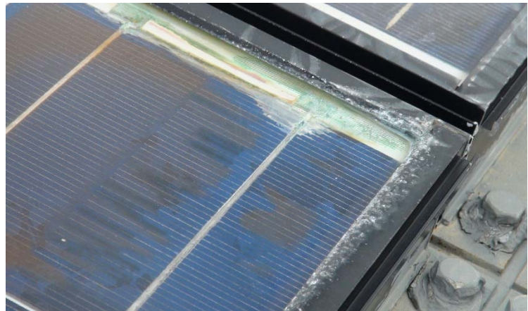
図 4.R3.4-4 旧モジュールの多くにみられる「バスバー-インターコネクタ」間の緑青
