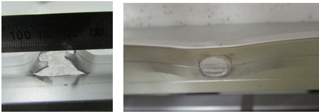
図 3.2.1-5 砂袋による終局耐力試験, 二種類の破壊形態
