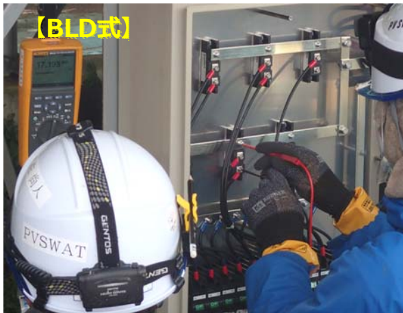
(a)ブロッキング・ダイオードの場合の測定箇所
