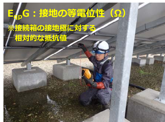
(c)接続箱の接地極と各モジュールのフレームとの間の抵抗値の測定
