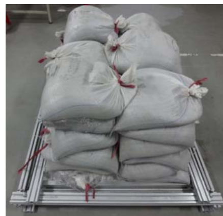
図 3.2.1-4 砂袋による終局耐力試験
