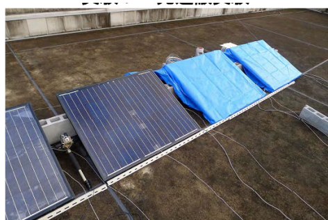
図 遮光効果の観測 2Ωの負荷抵抗を設置 (右から、ブルーシート2枚、ブルーシート1枚、普通モジュール)
