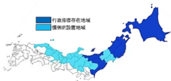
図 A.3-5 雪止めの設置地域区分(JASS12)
