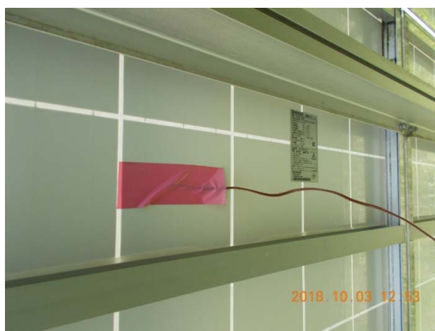
図 4.R3.1-5 裏面から熱電対が埋め込まれていたモジュール(ストリング#03)
