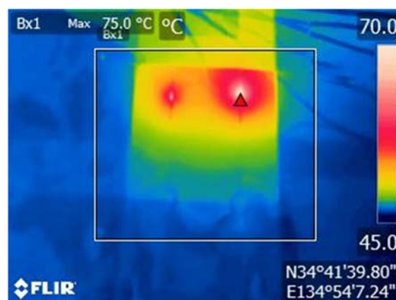
図 4.R3.8-8 #02-09 に接続されたあるモジュールの表面温度分布(裏側)の近接写真
