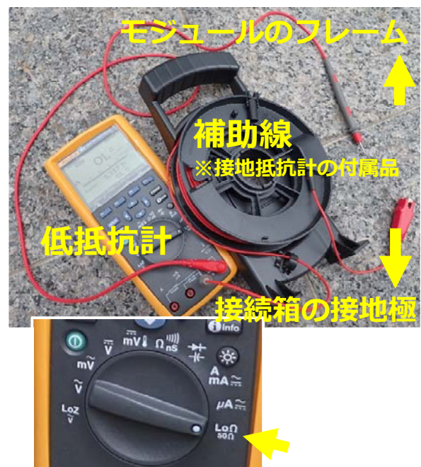
(b)低抵抗計の接続と設定
