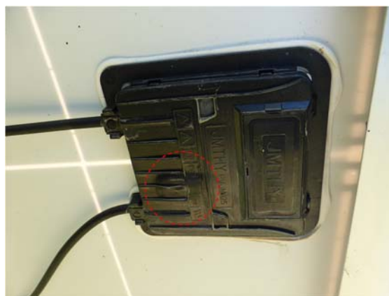
(b)カバーが変形した端子箱
