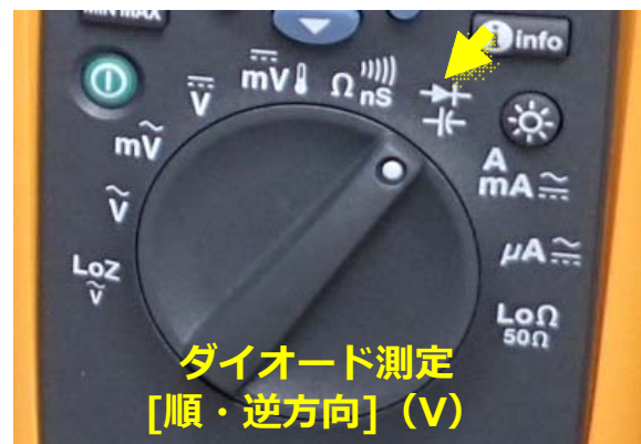
(d)マルチメータのダイオード測定モード
