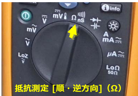
(c)マルチメータの抵抗測定モード
