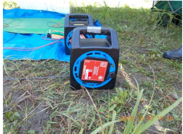
(a)延長リールの例(50m, 1Ω程度)
