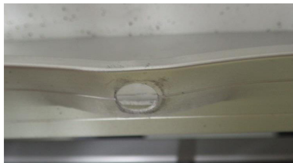
図 3.2.1-5 砂袋による終局耐力試験, 二種類の破壊形態
