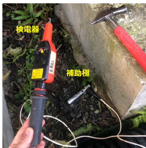
図 4.R2-3 直流検電器の例 (長谷川電機工業株式会社 HSN-6A 型)
