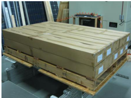
図 3.2.1-3 木材による終局耐力試験
