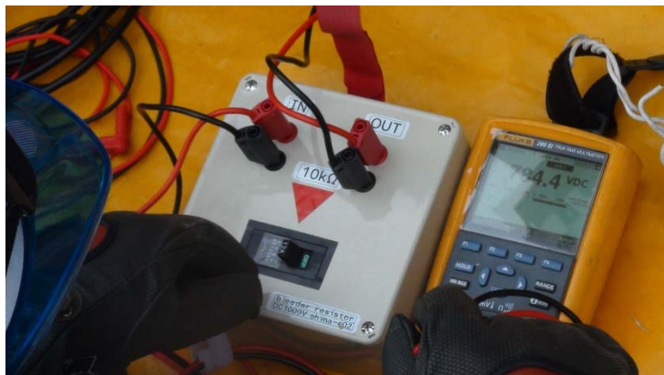
図 4.R3.6-12 ブリーダ電圧の測定
