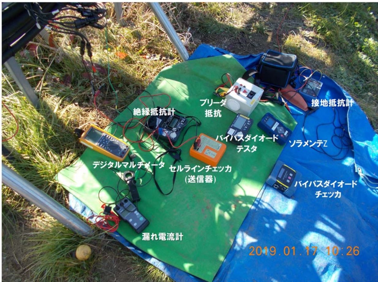
図 4.R3.11-1 調査に用いた主な測定機器
