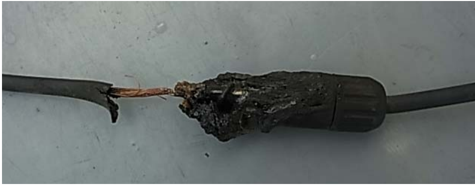
図 3.5.1-1 多点地絡により発火したコネクタ
