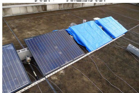
図 遮光効果の観測 2 \Omega の負荷抵抗を設置 (右から、ブルーシート2枚、ブルーシート1枚、普通モジュール)
