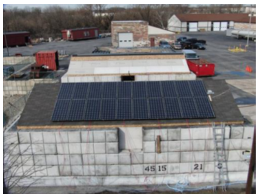
図 B4.1-7 実規模アレイによる燃焼実験
