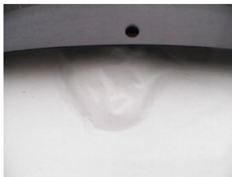
図 4-4 はんだ接続部の発熱により剥離したバックシートの例
