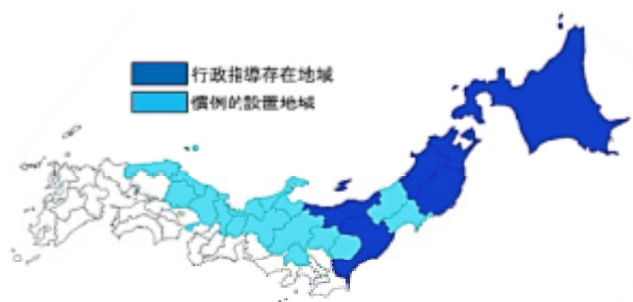
図 A.3-4 雪止めの設置地域区分 (JASS12)
