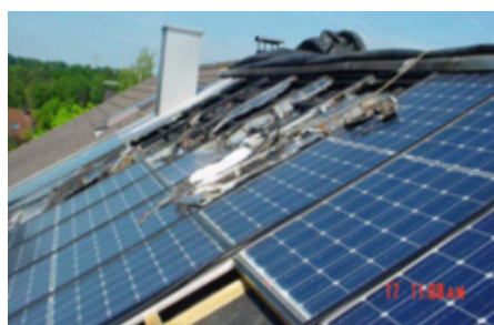
図 3.2.1-2 風による反復荷重の影響によるモジュールアーク事例 (参考文献：BP solar Wohlgemth)
