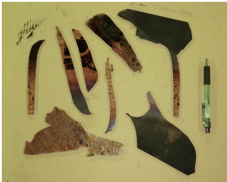
図 2-16 モジュールから脱落したガラス片 15
