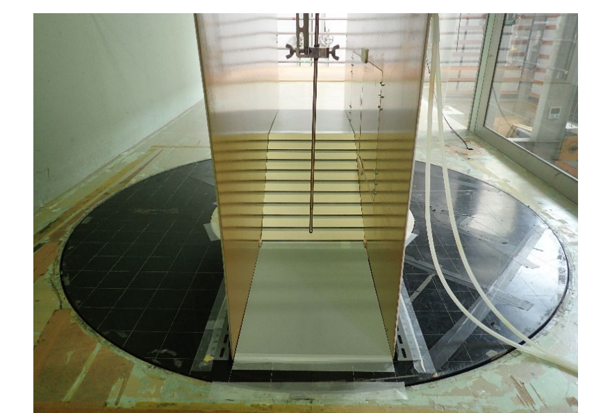
風洞実験(傾斜地)
