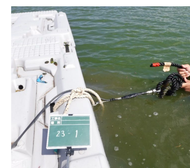
係留索への荷重測定
