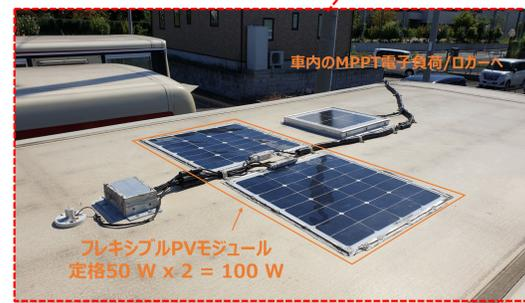
運行中の発電量モニタリングを実施してきたが、路線バスはディーゼル駆動のため、PV電力との突合せ評価が困難であった。→ 本研究では、EVを用いた走行データとPV関連データの同時取得を実施。
