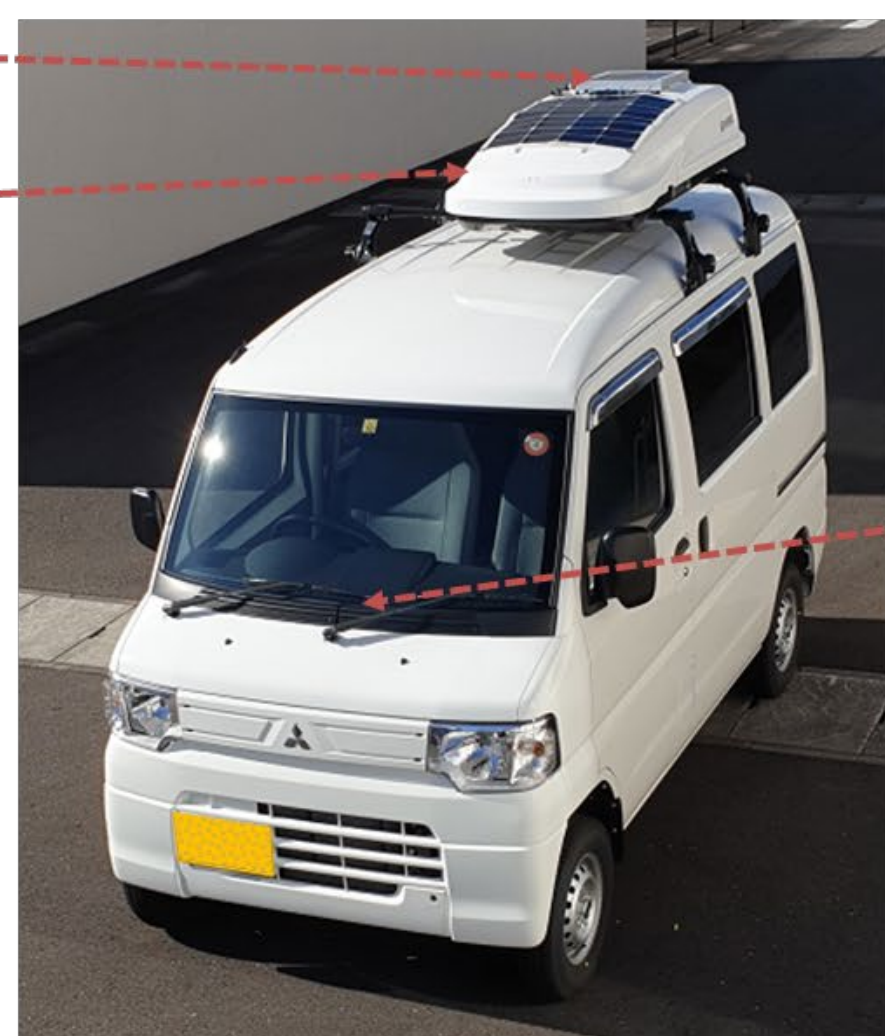
PVモジュール + バッテリー (独立電源) で稼働
