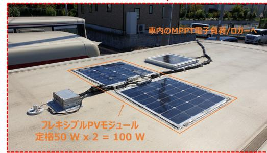
車内のMPPT電子負荷装置・データロガーに接続(測定間隔1秒)。GPSレシーバーによるバスの位置情報も同時に取得
