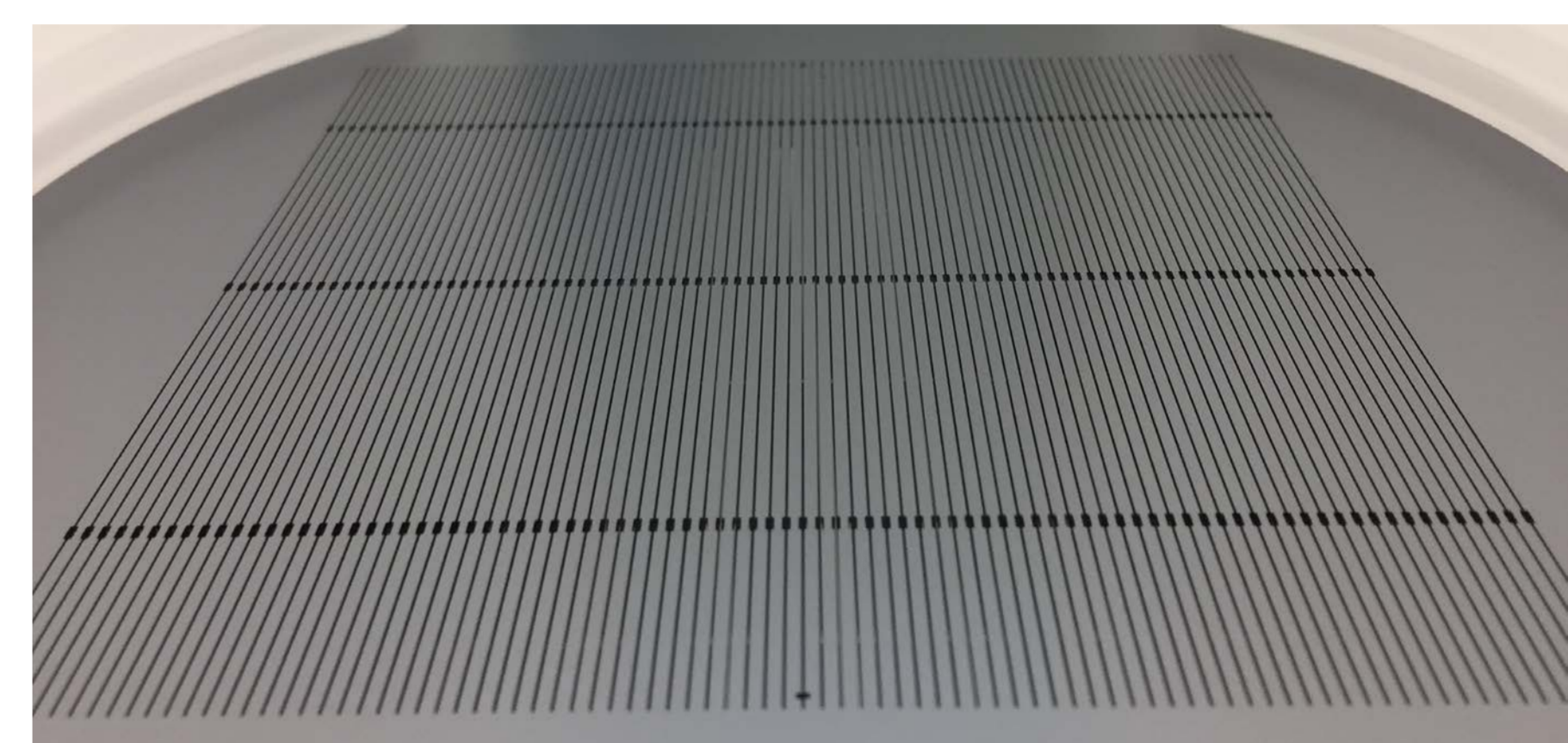
図2 シリコン製ステンシルマスク(200mmΦシリコン基板)
