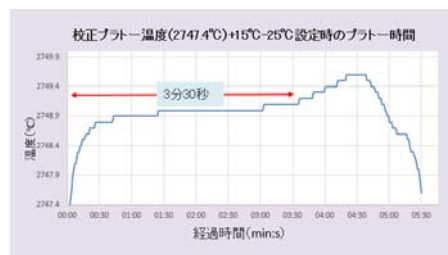
図3 校正プレート温度(2747.4°C)+15°C-25°C設定での運転特性
