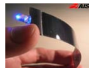
超軽量・高性能フレキシブルCIGS太陽電池 には アルカリ不純物制御が不可欠
