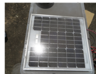
Fig. 3. 降灰時の太陽電池モジュール外観
