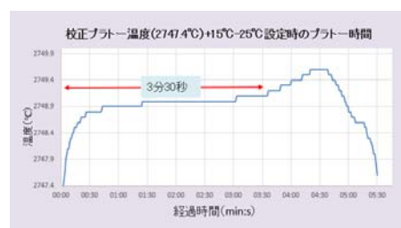
図3 校正プラトー温度(2747.4°C)+15°C-25°C設定時の運転特性
