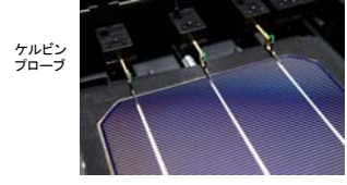
ケルビンプローブを使用した影なし測定 [1] と照度補正
