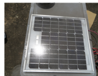
Fig. 3. 降灰時の太陽電池モジュール外観
