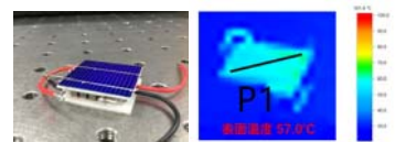
図9 デバイス(左、M=9)と赤外線サーモグラフィ像(右、光照射下 4.6 suns、下面 25°C)
