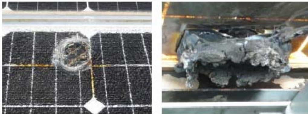
ジャンクションボックスが焼損した例
