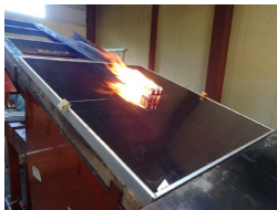
図-11 飛び火試験(第63条) 薄膜シリコンモジュール(受光面ガラス、背面封止材1枚、PVF/PET/PVF使用)
