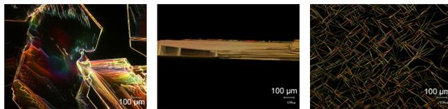
4CF<sub>3</sub>の偏光顕微鏡写真 : PDMS上に5 mm×1 cmの平板結晶
