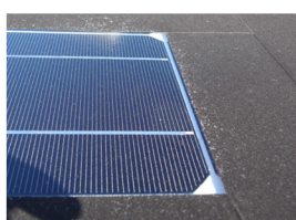
図7 入射角が大きい時、マスクが作る陰
