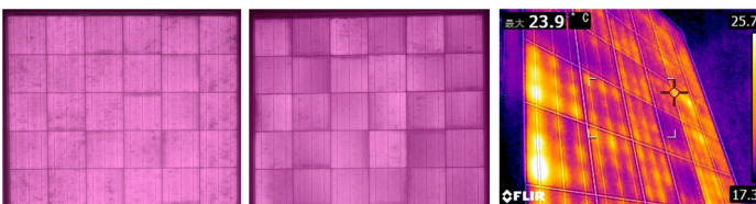
図5. 未使用パネルのEL結晶欠陥の暗部があるがセル面内が同等の明るさ
